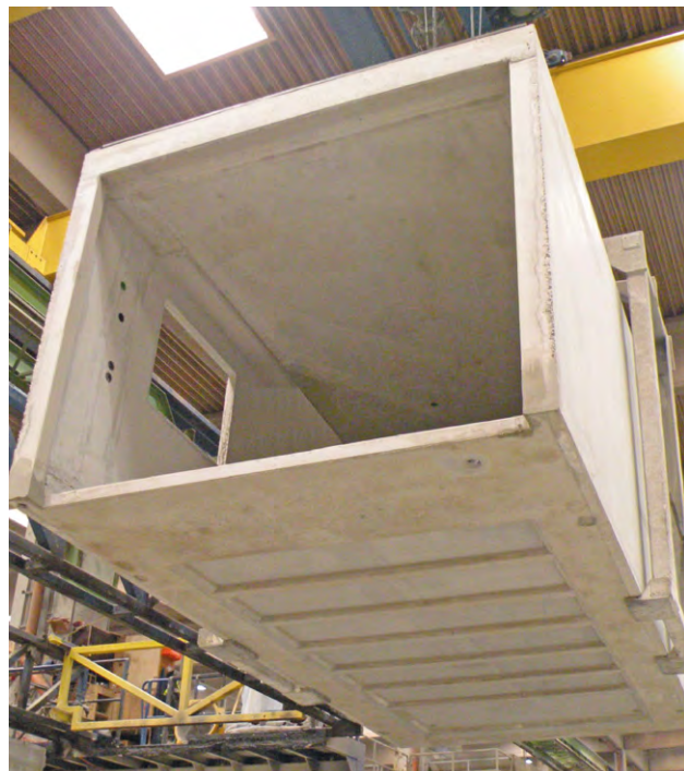
Ansicht der Bodenplatte aus Carbon-/Textilbeton.
