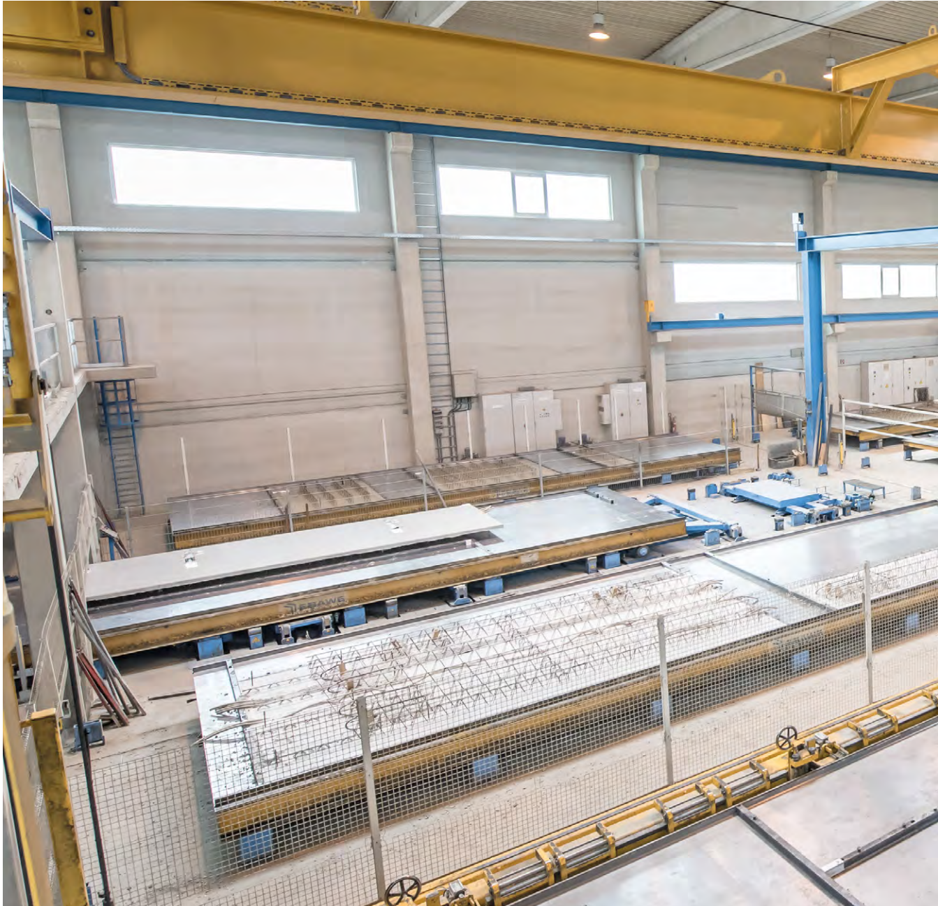
Der Blick in die Produktionshallen zeigt den hohen Automatisierungsgrad bei der Betonfertigteilherstellung.
