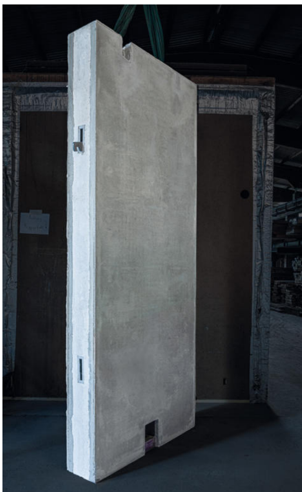
Eine vorgefertigte Wand aus Gradientenbeton.
